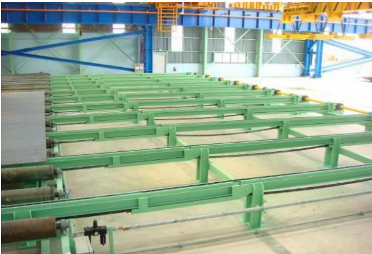
钢材预处理线（4.5m 宽，6m/min ）横移输送系统
