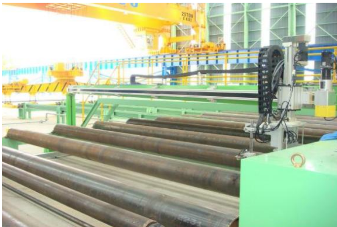
钢材预处理线（4.5m 宽，6m/min ）编码打印系统
