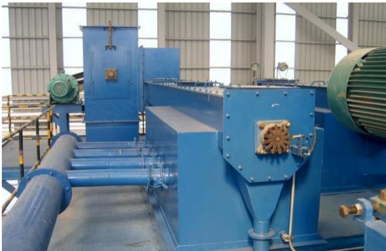
钢材预处理线（4.5m 宽，6m/min ）丸尘分离系统
