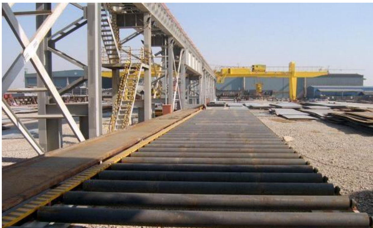
钢材预处理线（4.5m 宽，6m/min ）上下料辊道输送系统
